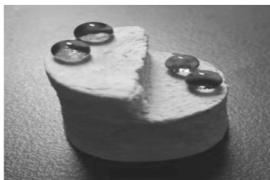
图 7 亚甲基蓝溶液在改性气凝胶表面和内部的宏观图
