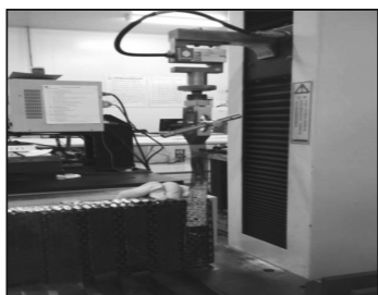
图 7 180^\circ 剥离强度拉伸试验图
