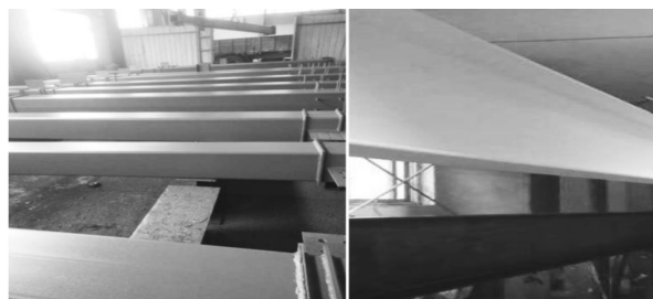
图 2 水性醇酸树脂防腐涂料涂装过程构件示意图
