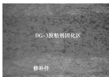
图 4 缺陷试样贴补修补的胶界面金相图
