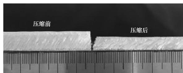
图 6 三维中空夹芯织物复合材料试样压缩前后的形貌图
