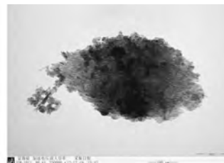
图 5 Fe@Cu4N 的 TEM 图
