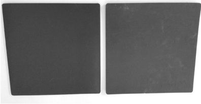
图 2 硼基苯基硅橡胶示意图
